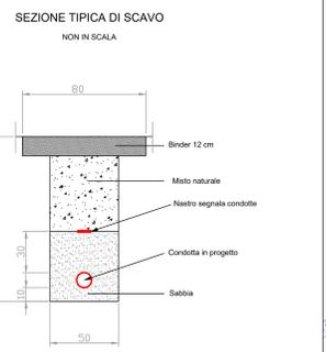
Nota: in attesa del ripristino con binder lo scavo deve essere tamponato con uno strato di misto stabilizzato dello spessore di almeno 10 cm
