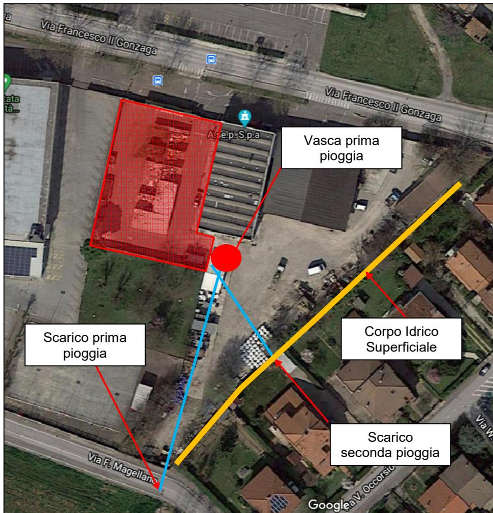
La rete fognaria di raccolta delle acque meteoriche è presente sull'intera superficie del C.d.R. ed è convogliata interamente verso un pozzetto partitore posto a Sud nel piazzale del deposito comunale.
