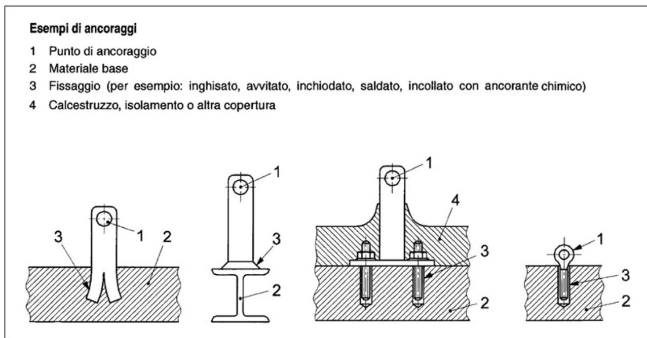
Quando il materiale base è a vista, come ad esempio travi di coronamento, parapetti e aggetti in cemento armato, coperture in lamiera, sarà indispensabile superare il pacchetto di copertura per individuare gli elementi
