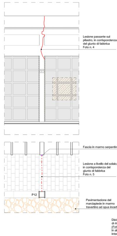
Planta e prospetto campata F
