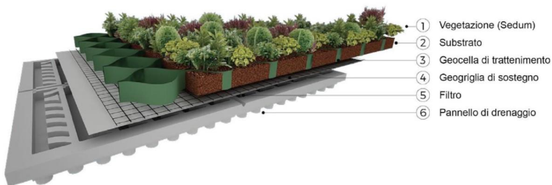
Schema stratigrafia della Copertura Verde
